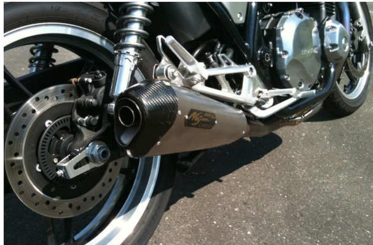
独特な異型断面のLOCK-ONだからこそできたマフラーの取り廻しと、チタンの軽さとノジマならではのSC集合でCB1100がスポーツ性能を手に入れました。もちろん排ガス規制・騒音規制をクリアした政府認証マフラーです。(画像ではテスト等で熱がかかっている為エキパイが焼けていますが、実際の製品は焼き色無しです)
